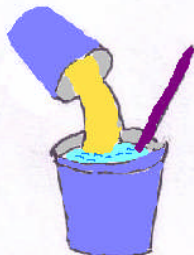
5: Mezclar con agua y dejar Reposar 24 horas
